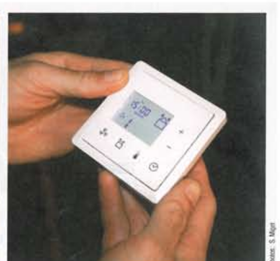
► L'ensemble du système, chauffage et ventilation, est piloté par une régulation performante. C'est elle qui gère, en fonction de la demande en température, le réchauffement plus ou moins important de l'air par l'appoint de chauffage bois ou de panneaux solaires.
